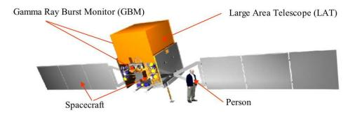
Fig. 1 The GLAST payload.
